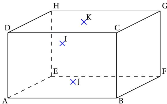
On considère le parallélépipède rectangle ABCDEFGH et les points I, J, K tels que I et J sont dans (ABC) et  $K \in (EFG)$ , comme sur la figure ci-contre. Dessiner la section du parallélépipède par le plan (IJK).
