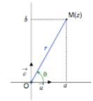
Dans le plan complexe, on dit que le point M a pour affixe z = a + ib (écriture algébrique) ou  $z = r(\cos\theta + i\sin\theta)$  (écriture trigonométrique),
